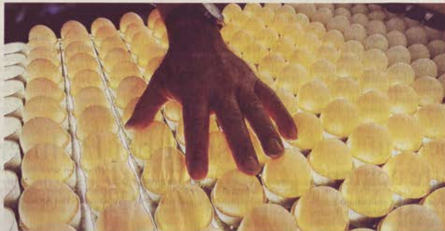
Einwandfreie Qualität wird vom rohen bis zum gefärbten Ei kontrolliert: Bevor die rohen Junghennen-Eier in die Kochwanne gleiten, werden sie durchleuchtet .
